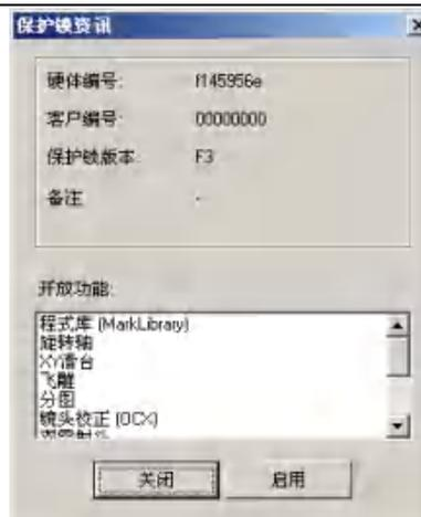
在保护锁有设定密码的情况下，每个字段皆有正确数值，但多了个「启用」钮。
