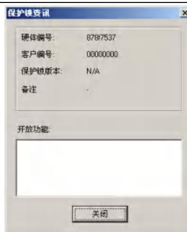
硬件编号数值正常，但部份字段的数值异常，表示保护锁验证失败或是跳过验证程序。使用INI纪录的客户编号与保护锁纪录的编号不符、软件锁写入的格式错误等原因皆会导致发生此种错误。此时请联络软件供货商以寻求解决。
