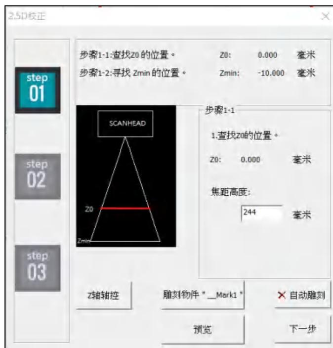
步骤二. 还未设定前, 焦距位置移到默认值 (-10) 的位置, 用户寻找到  $Z_{min}$  的位置, 并填入焦距高度, 将自动算出  $Z_{min}$ , 如下图。
