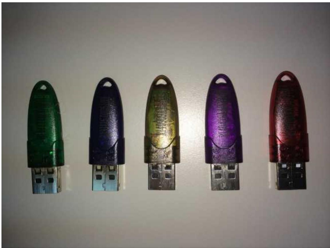
KeyUpdate.exe 置于 MarkingMate 的安装目录内，是保护锁专用的工具程序。可对保护锁进行升级模块，版本更新，和设定密码等操作。
