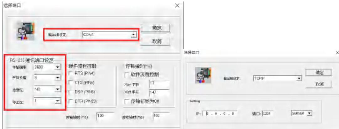
**输出埠设定** 使用者可设定使用 ComPort 或 TCP/IP 传输远程控制命令。选择 COM1~COM8 是选择使用 ComPort，选择 TCP/IP 则是选择使用 TCP/IP。
