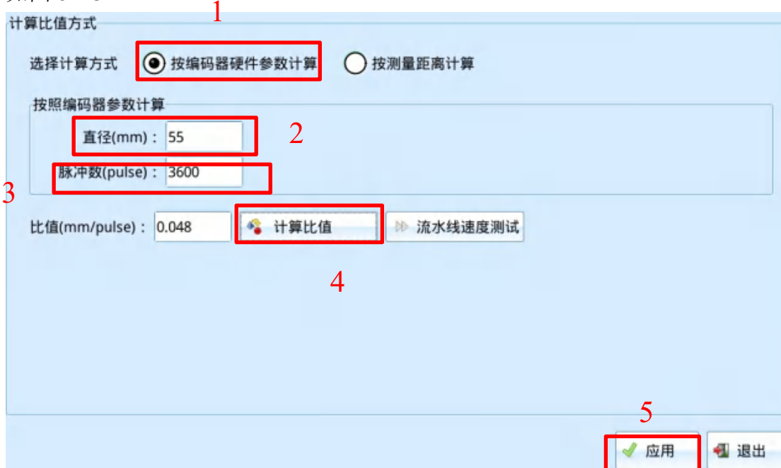
图 6.2.8 按编码器硬件参数计算比值
